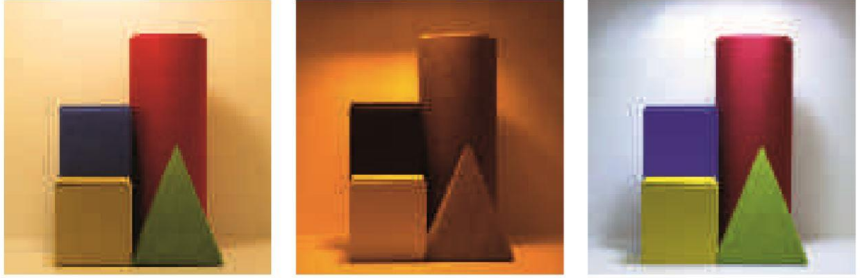
الشكل (35) يمثل الأداء اللوني لبعض مصادر الإضاءة الصناعية المختلفة المصدر : (Philips Electronics,2008)
